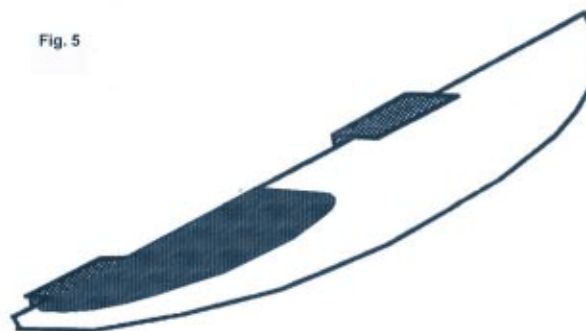
Fig. 5 Reforço com espuma de PVC para dar resistência às áreas do mastro e quilha.
